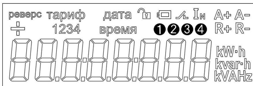
Рисунок 6 - Общий вид ЖКИ счетчиков в корпусе 7mTH35
